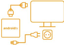
Schließen Sie die Android Box mit dem Netzteil an eine Stromquelle an und verbinden Sie die Box via HDMI-Kabel mit Ihrem Fernsehgerät.
