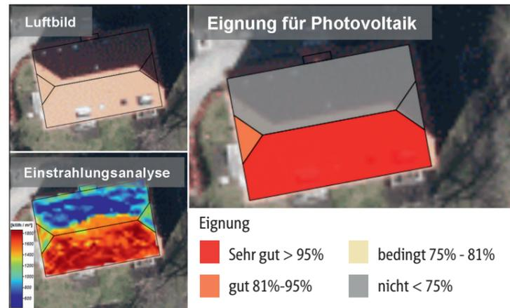
Im Solarpotentialkataster kann mit Hilfe des Luftbildes eine Dachfläche in Schwerin ausgewählt und die entsprechende Eignung für die Nutzung von Photovoltaik oder Solarthermie festgestellt werden. Grafik: geocontent
