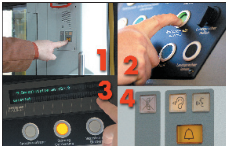
Über die Sprechanlage an den Doppeltüren können Fahrgäste im Notfall Kontakt zum Fahrer aufnehmen Collage: maxpress/max
