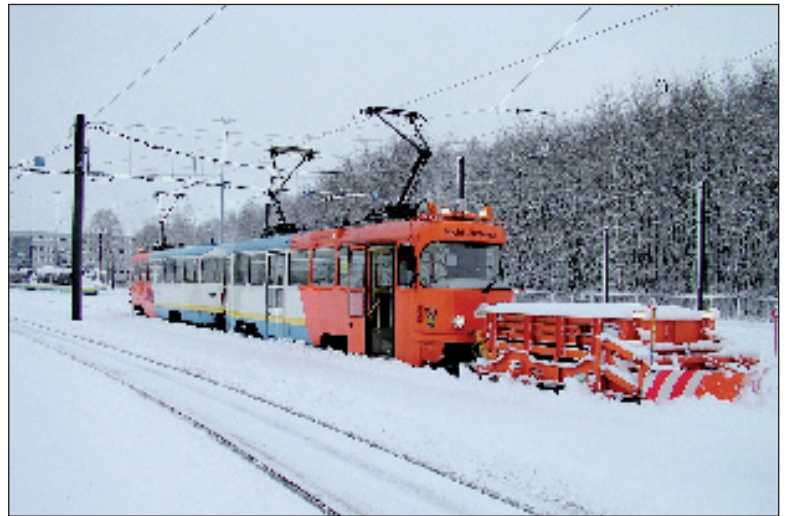
Der Arbeitswagen des Nahverkehrs ist mit einem Schneepflug und einer speziellen Hydraulikanlage ausgerüstet Foto: NVS
